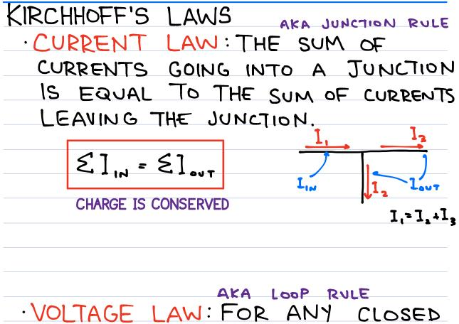
LOOP, THE SUM OF THE VOLTAGE GAINS IS EQUAL TO THE SUM OF THE POTENTIAL DROPS.
